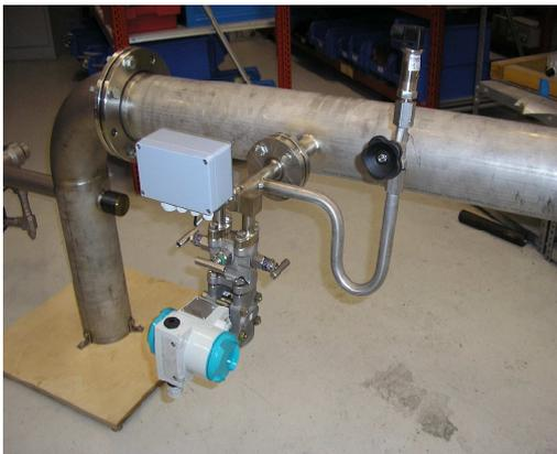
Zur Temperaturnaufnahme dient entweder ein Miniatur-PT100-Widerstandsthermometer oder ein Thermoelement Typ K. Diese befinden sich in einer geschlossenen Tauchhülse in der deltaflow und können zu Test- oder Austausch Zwecken unter Druck gezogen werden. Hierfür muss die Sicherungsmutter ganz geöffnet werden. Das Element kann dann gezogen werden. Ein Austauschelement muss dieselbe Länge haben wie das Originalelement und darf einen Außendurchmesser von max 2 mm
